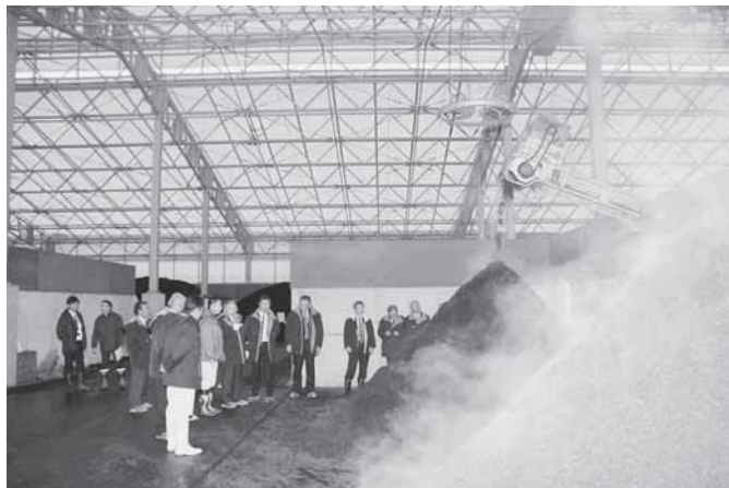
畜産農家から排出される牛ふん・豚ふん・鶏ふんとモミガラを原料に堆肥を製造
