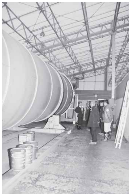
東北初のロータリーキルンで混合と一次発酵を行う（φ3m×21.5m×2基）
