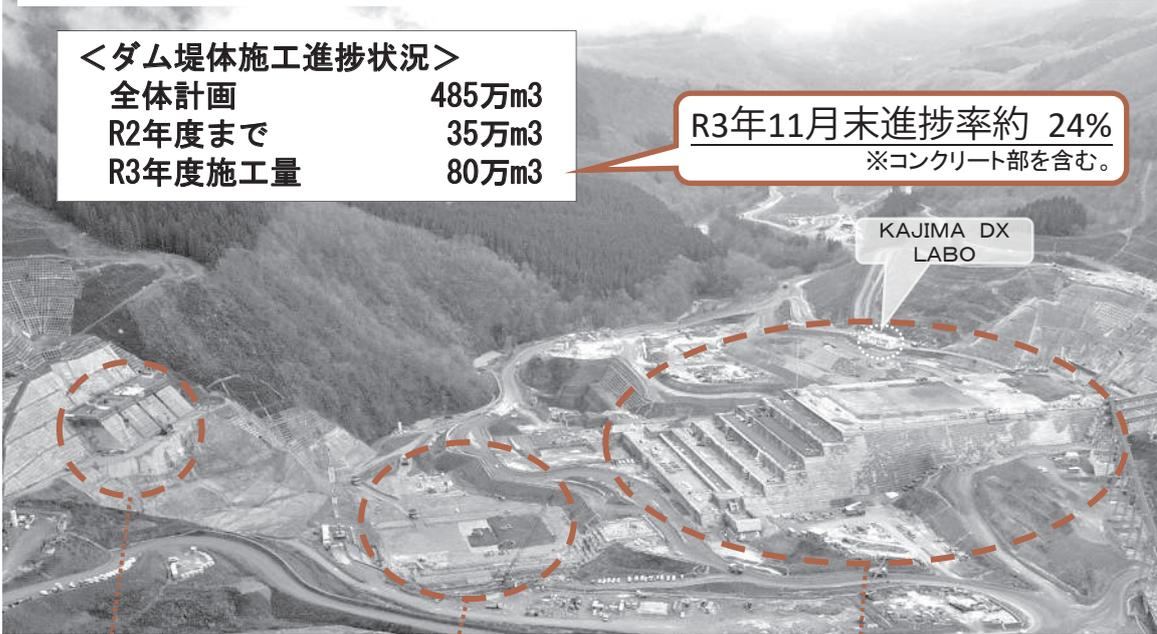
CSG 施工状況図(ダム本体を上流側からみた図)
